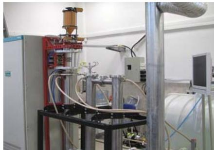
Високочестотна плазмохимична инсталация за получаване на наноразмерни материали
