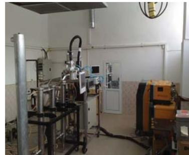
Електродъгова плазмохимична инсталация за получаване на наноразмерни материали
